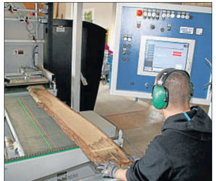
Millimetergenau: Per Computer, rechts die Elektronik, schneidet Jörg Kilian das Brett zu. Mit Laserstrahlen hatte der ausgebildete Holzbearbeitungsmechaniker zuvor die Stellen markiert, an denen er das Holz zuschneiden will. Fotos: Kruschmann
